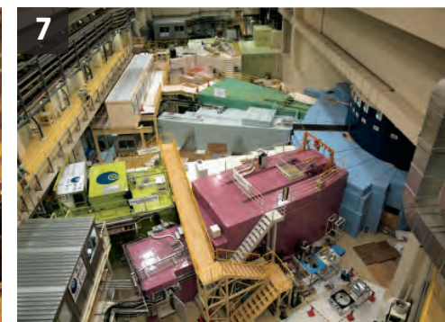
MLF の実験ホール 画面右の紺色の中性子源ステーションから左に向かって、 遮蔽体に覆われた中性子ビームラインが伸びています。画 面奥にはミュオンビームラインも見えます。
