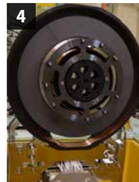
4 ミュオン生成標的 陽子を衝突させミュオンのもととなるπ中間子を発生させるための標的。黒鉛でできた標的の周囲を放熱のための銅で囲っています。
