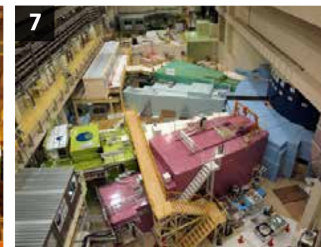
7 MLFの実験ホール 画面右の紺色の中性子源ステーションから左に向かって、遮蔽体に覆われた中性子ビームラインが伸びています。画面奥にはミュオンビームラインも見えます。
