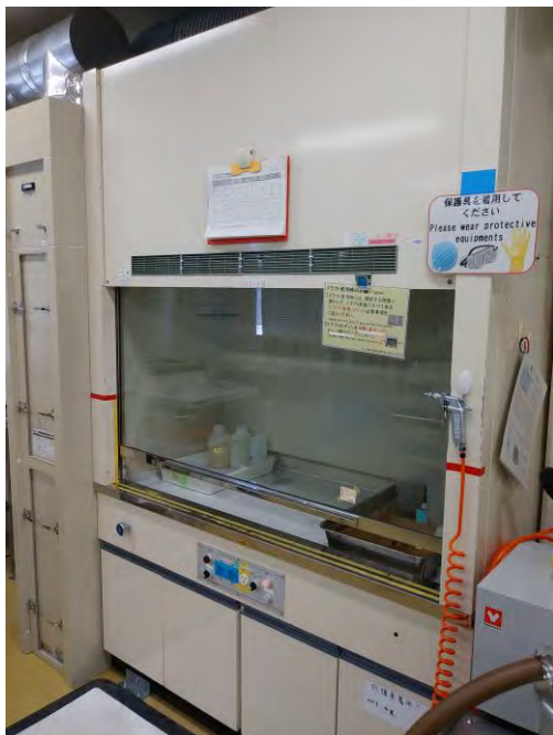
ヒュームフード（排ガス処理装置付き）
